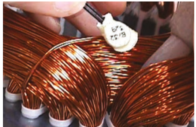
Figura 7.6 - Instalação do protetor térmico bimetálico
