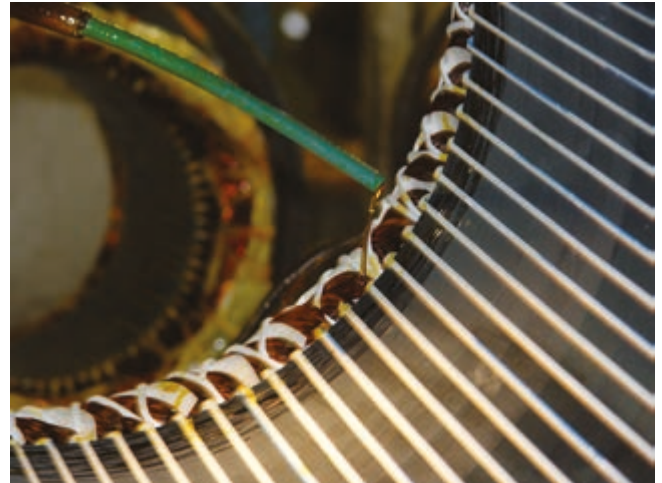
Figura 1.12.c – Fluxo contínuo de resina
