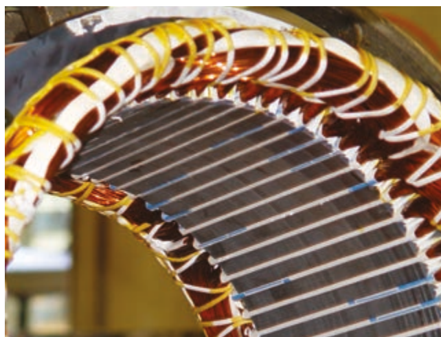
Figura 1.12a – Fios e Filmes aplicados no estator
