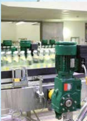
Acionamentos NORD utilizados em um equipamento de engarrafamento em uma cervejaria no sul da Alemanha.
