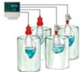
Controle e monitoramento de nível em reservatórios
