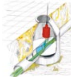
Medição de vazão ou nível em local úmido e de eventual submersão
