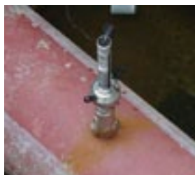
Montagem em tap 1" dentro de PV com água
