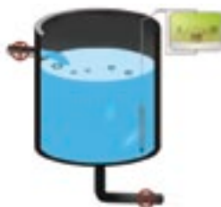
Sensor de cerâmica para medição de nível de esgoto e efluentes
