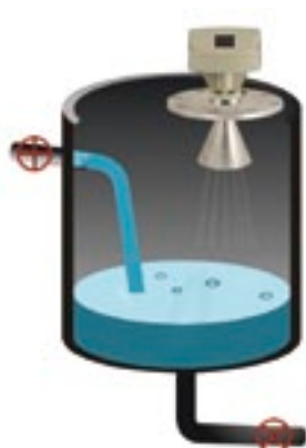
Antena revestida (PP ou PTFE) para produtos corrosivos
