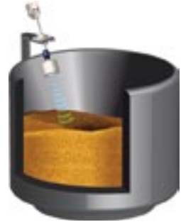
Medição de nível de pós, granulados e sólidos
