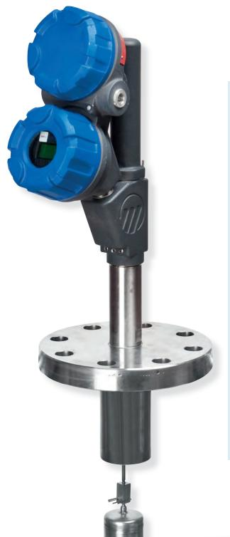
A força de flutuação atua no deslocador, o qual se movimentará verticalmente para dentro (aumento do nível de líquido) e para fora (diminuição do nível de líquido) do transformador diferencial linear (LVDT). Devido à movimentação, tensões são induzidas nas bobinas secundárias do LVDT. Então, esses sinais são processados nos circuitos eletrônicos e utilizados para controlar o sinal de saída.
