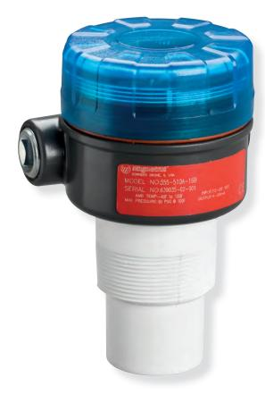
A medição de nível é realizada emitindo-se um pulso ultrassônico a partir da face do transdutor e medindo-se o tempo decorrido entre o envio desse pulso e seu eco refletido a partir da superfície do líquido. Como a velocidade do som é dependente da temperatura, o transdutor também mede a temperatura ambiente para compensar a mudança de velocidade.
