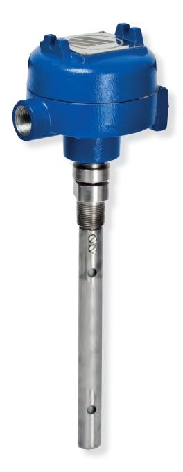
O líquido age como um isolante entre dois condutores (sonda e parede do tanque). Quando o nível aumenta, ocorre maior ganho de capacitância em um sinal analógico ou digital.
