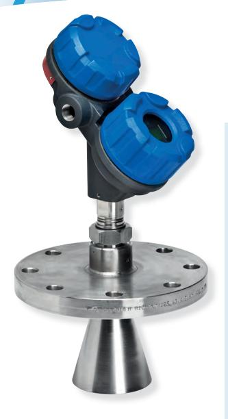
O Radar por Propagação de Pulso emite curtos disparos de energia para uma superfície líquida. Um circuito de temporização de ultra-alta velocidade mede o tempo do sinal refletido na superfície líquida.
