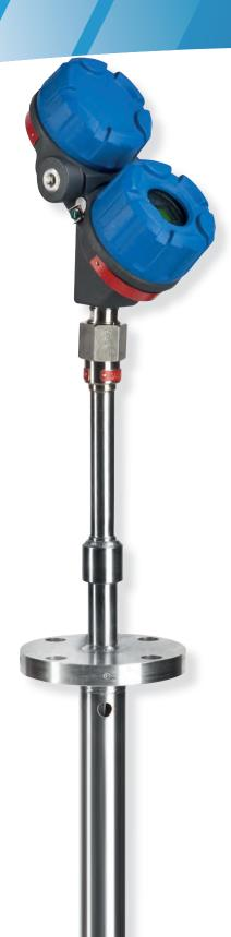
O Radar por Onda Guiada é baseado na tecnologia de Reflectometria por Domínio de Tempo (time domain reflectometry, TDR). A TDR utiliza pulsos de energia eletromagnética que são transmitidos por uma sonda. Quando um pulso atinge uma superfície líquida que tem um dielétrico superior ao ar/vapor no qual ela se desloca, o pulso é refletido.
