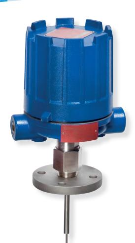
Um ímã permanente é fixado a um atuador de chave articulado. Conforme a boia/deslocador eleva-se seguindo o nível do líquido, ele eleva o núcleo de atração para dentro do campo do ímã, que então se encaixa no tubo de invólucro não magnético, acionando a chave. O tubo de invólucro fornece uma delimitação de pressão estática entre o mecanismo da chave e o processo. No nível descendente, a boia/deslocador desativa a chave.
