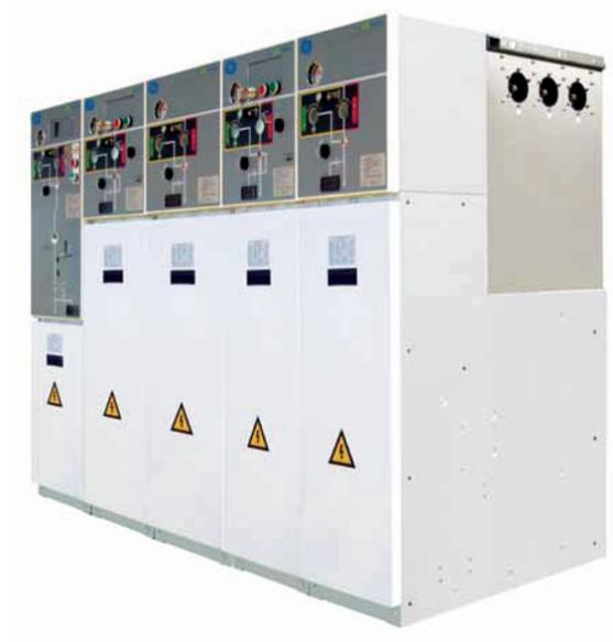
O SecoRMU é um compacto, modularizado e expansível painel de média tensão isolado em SF6 para distribuição secundária de energia, especialmente projetado para configurações em anel, com seus barramento horizontais imersos em um tanque de aço inoxidável com gás SF6, garantindo altos níveis de confiabilidade e desempenho, além de custos otimizados de aquisição, operação e manutenção.
