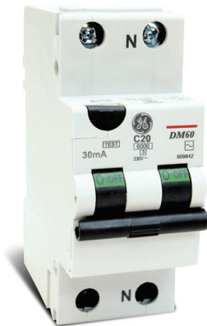
Os DDRs (Disjuntor com Proteção Diferencial) são disjuntores com proteção diferencial, onde já estão incorporados em um único produto as funções do DR (Interruptor Diferencial) e do mini-disjuntor. O DDR possui proteção diferencial contra contatos diretos e indiretos e contra sobrecarga e curto-circuito. Sendo assim, ele tem a função de proteger as pessoas dos efeitos maléficos de um choque elétrico e os equipamentos (patrimônio).
